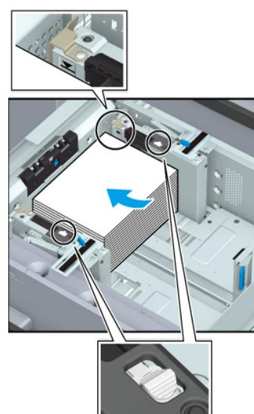
При загрузке бумаги с плотностью более 401 г/м<sup>2</sup>/107 фнт (документная бумага) заблокируйте только **рычаг пластины фиксации бумаги** на задней стороне.
