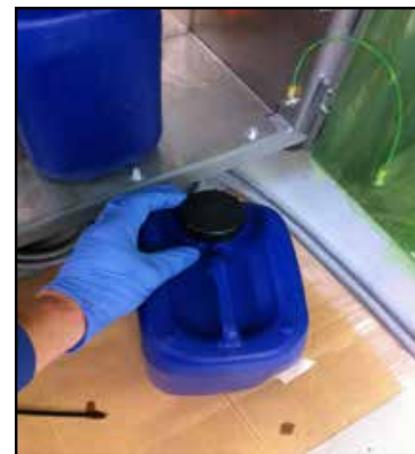
Вставьте крышку до упора, трубкой вовнутрь контейнера.
