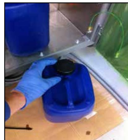
Установите контейнер для отходов таким образом, чтобы внутрь него входили две трубки.
