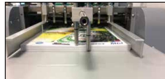
После этого можно приподнять стопу, чтобы остановить лоток подачи верхним ограничителем стопы. Допускается регулировка высоты этого датчика (черный винт с накатанной головкой). Высота стопы определяет корректный захват печатных основ в области подачи выравнивающего стола.
