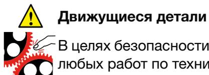
В целях безопасности отключайте движущиеся части, обозначенные этим символом; отсоединяйте штекер электропитания перед выполнением любых работ по техническому обслуживанию или ремонту оборудования.
