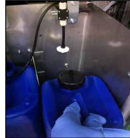
Привинтите фильтр для очищающего агента с трубкой, погруженной в очищающий агент. Предостережение: капли очищающего агента могут стекать с фильтра во время работы.
