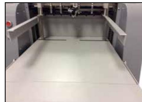
Подъем и опускание загрузчика печатных основ регулируются в левой части лотка подачи печатных основ. Синяя кнопка используется для активизации компрессора аппарата и управления захватом печатных основ путем переноса захвата на выравнивающий стол.
