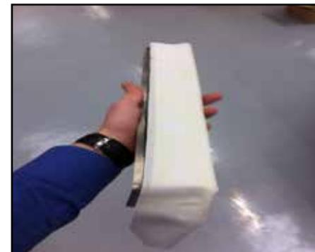
7- Зажмите ткань в гибком зажиме (a) внизу и винтовой опоре (b), предназначенной для этой цели. В итоге ткань должна быть расправлен, туго натянута и зафиксирована на блоке протирки (c).
