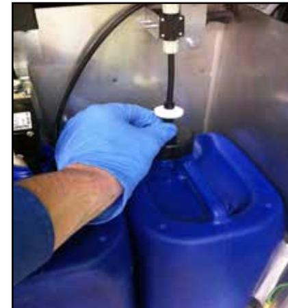
*Примечание: после опорожнения контейнера на управляющий модуль и в интерфейс 3DS Hub Manager выводится сообщение. Для удаления пустого контейнера для очищающего агента выполните действия в обратном порядке.*
