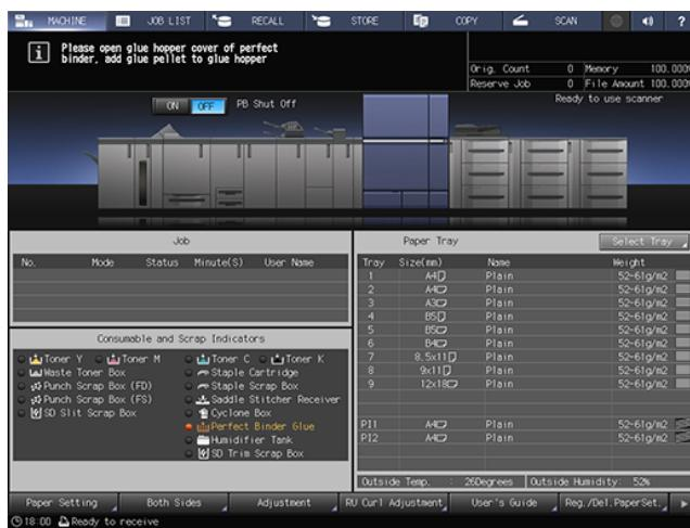
Добавьте клеевые гранулы в **устройство клеевого скрепления PB-503**.
