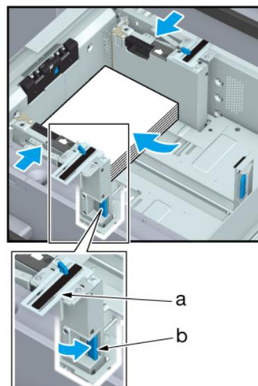
**4 Поверните ручки блокировки боковых направляющих** (в 2 местах) по часовой стрелке и зафиксируйте их.
