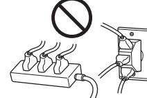
Не используйте удлинители. Использование удлинителя может стать причиной возгорания или поражения электрическим током. Если шнур питания, входящий в комплект, недостаточно длинный для подсоединения к стенной розетке, обратитесь в техническую службу.
