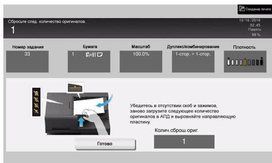
Загрузите оригинал или бумагу и нажмите [ОК] или [Complete] (Готово). Система снова запускает процесс сканирования или печати оригинала.
