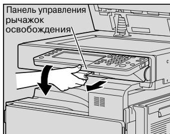
Панель управления фиксируется в среднем положении.
