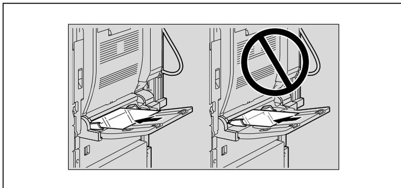
*Перед загрузкой конвертов выдавите из них воздух и убедитесь в том, что сгибы клапанов плотно прижаты. В противном случае конверт может помяться или застрять в аппарате.*
