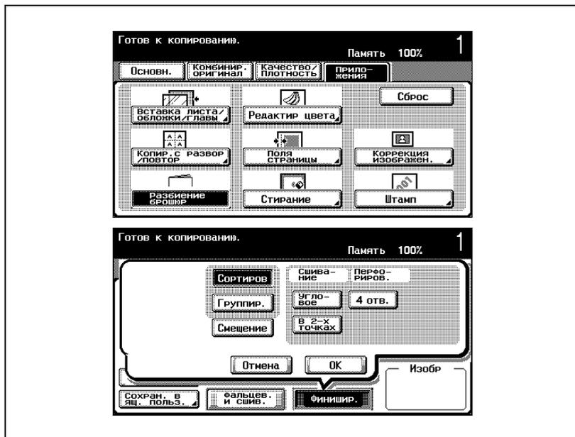
Настройка сшивания “Положение 2” автоматически отменяется, и устанавливается функция “Разбивка брошюры на страницы”. Чтобы выбрать “Положение 2” настройки сшивания, следует отменить функцию “Разбивка брошюры на страницы”, а затем выбрать настройку “Положение 2”.
