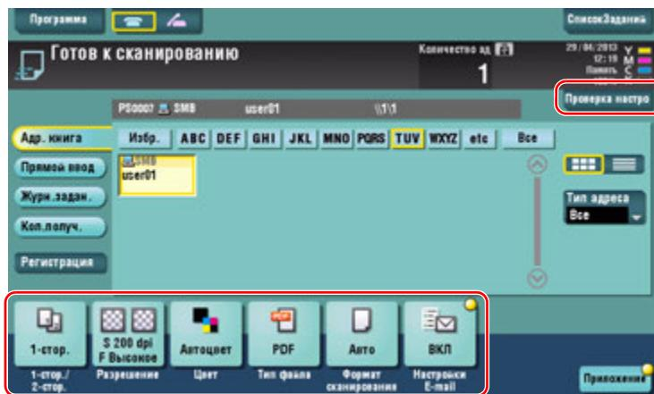
→ Позволяет проверить настройку, используя экранные кнопки на **сенсорной панели**.
