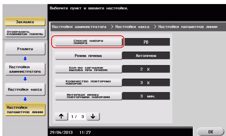
3 Для тонального типа кнопок, выберите [PB], а для импульсного типа, выберите [10 имп. в с].
