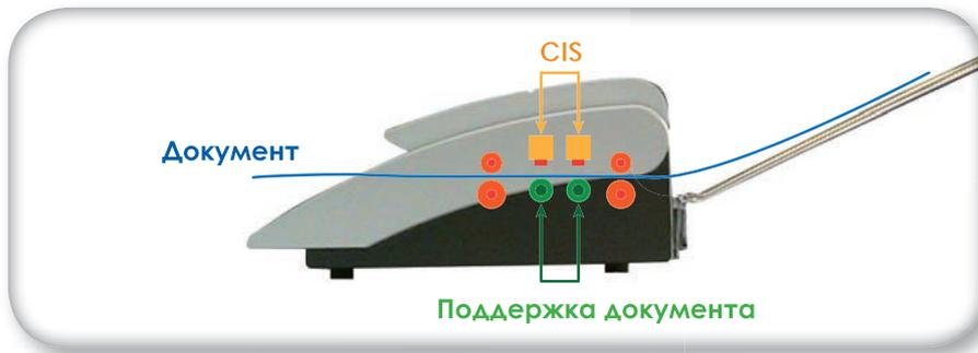
*Сканер KIP 720 характеризуется системой поддержки для улучшения надежности протяжки оригиналов*
