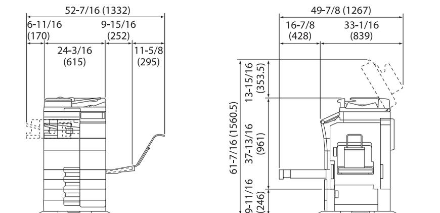
bizhub 558e/458e + PC-215 + FS-533 + MK-730 + CU-102 Единица измерения: дюйм (мм)
