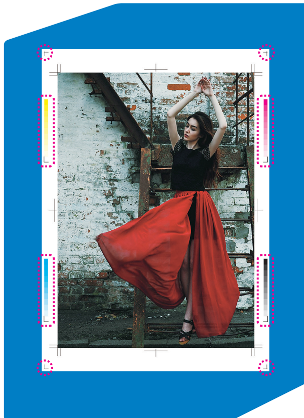
Автоматическая печать, сканирование и анализ меток приводки и градиентных шкал.
